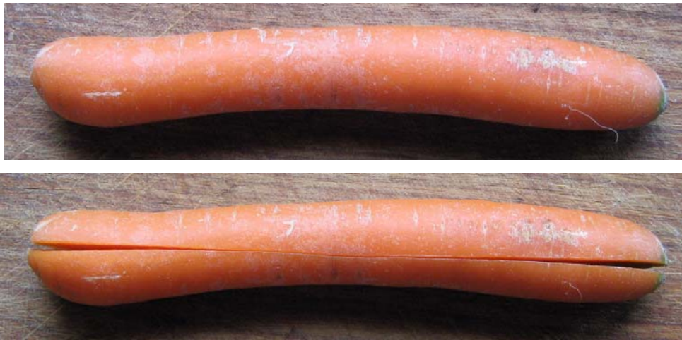
Karotte mit (schwachen) Eigenspannungen. Foto: Knödel 2009
