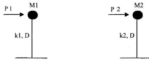
Bild 2.3: Modellierung der Kamine als Einmassenschwinger (aus [45])
