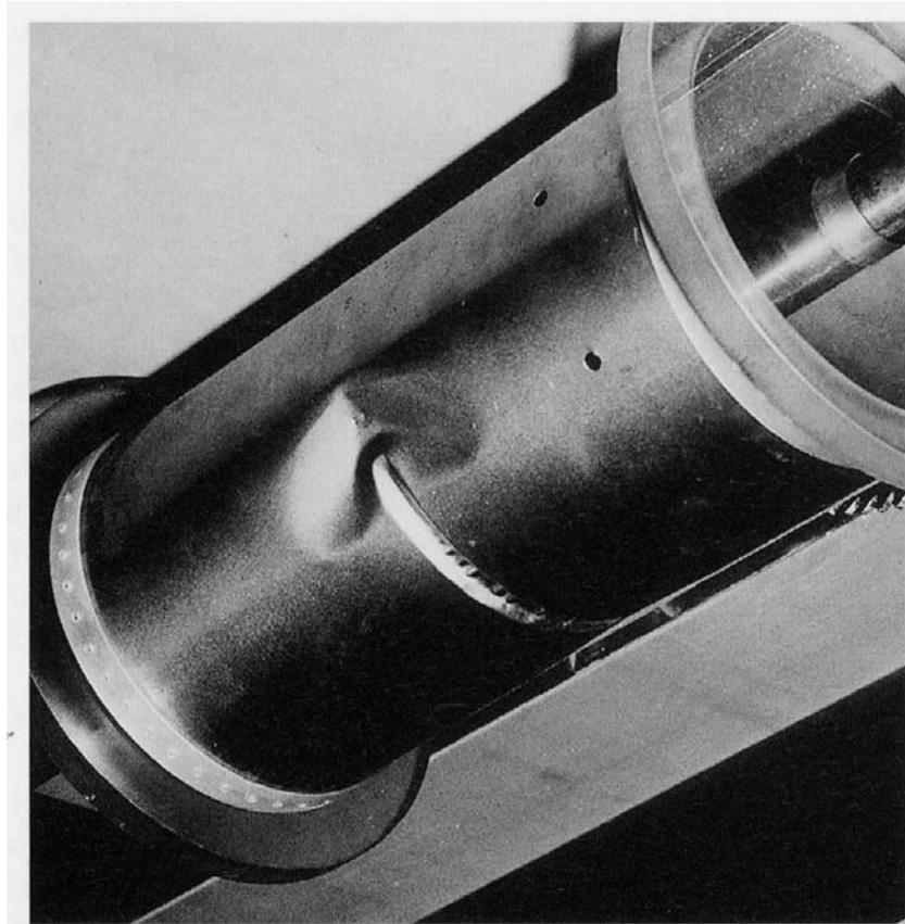
**Bild 9.** „Fußsohle“ infolge des plastischen Eindrückens des Sattels in den Zylindermantel eines Prüfkörpers ( $r = 65 \text{ mm}$ ;  $t = 0,3 \text{ mm}$ ;  $2\vartheta = 120^\circ$ ;  $f_y = 300 \text{ N/mm}^2$ ;  $Q_{pl} = 1440 \text{ N}$ )
